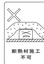
電源線は、断熱材の上を通過してください。
