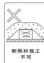
電源線は、断熱材の上を通してください。
