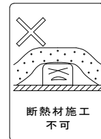
電源線は、断熱材の上を通してください。
