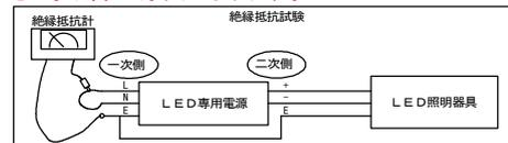
※LED専用電源一次側にて、DC500Vメガで両極一括と対地間を測定してください。二次側に試験を行う場合は、LED専用電源とLED照明器具を切り離し、LED照明器具側の+極一括と対地間を測定してください。
