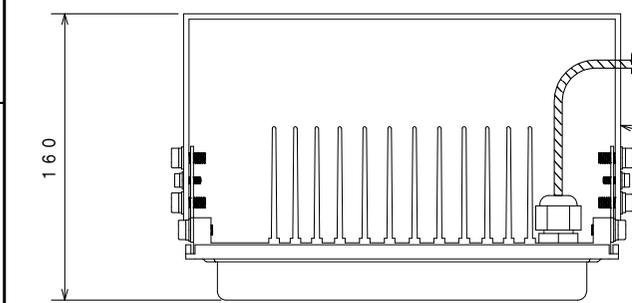
専用電源接続用口出し電線 VCT1.25sq-3C
