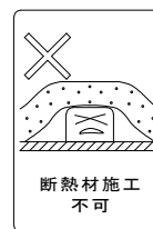
電源線は、断熱材の上を通してください。
